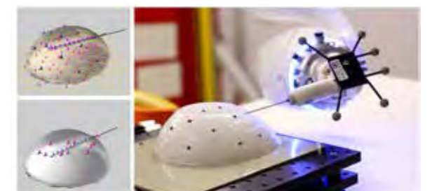
Simulation de pilotage d'aiguille de robot médical interagissant avec les tissus mous pour des applications d'ablation par radiofréquence de tumeurs profondes. Crédit : Laboratoire des sciences de l'Ingénieur, de l'Informatique et de l'Imagerie
