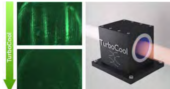
Gauche : disparition des turbulences optiques néfastes via la technologie TurboCool. Droite : illustration prévisionnelle du prototype d'amplificateur laser. Crédit : Centre lasers intenses et applications
