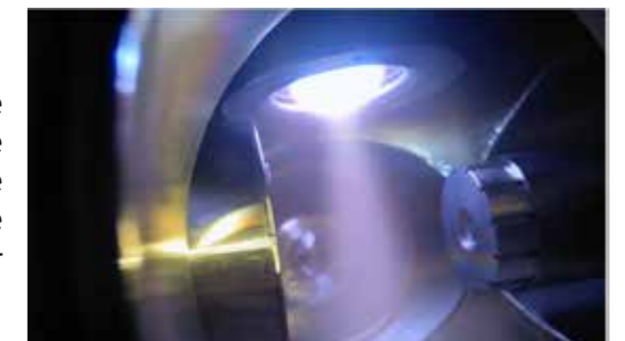
Dépôt de couches minces par pulvérisation plasma magnétron. Crédit : ISMO (A. Mukherjee)
